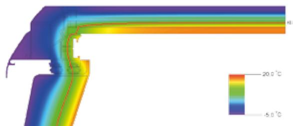
Andamento ottimizzato dell'isoterma per eccellenti coefficienti di isolamento termica
